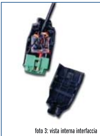
foto 2: cavo e interfaccia interna al connettore nero
